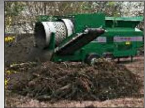
■ Die mobile Siebtrommel wird direkt auf das Grundstück gefahren, auf dem Boden durchgeseibt werden soll.
