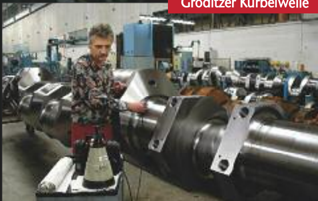
Mit Ultraschall wird die Reinheit des Materials geprüft.
