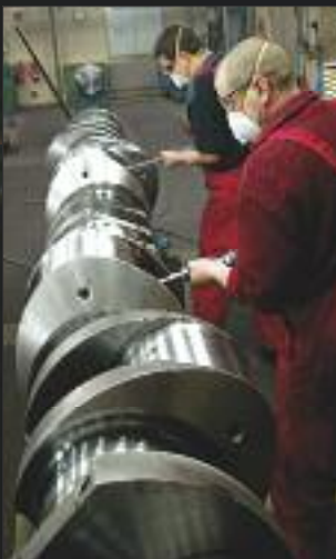
Per Hand werden die Schmierlöcher der Kurbelwelle nachbearbeitet.
